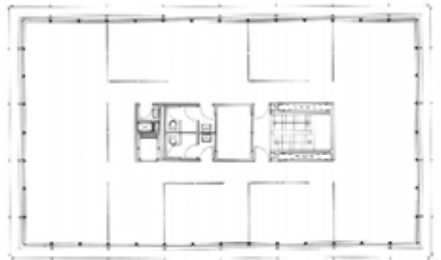
Grundriss eines Normalgeschosses mit den verstellbaren, augenhohen Trennwänden. Die Stützweite beträgt 4,00 m.
